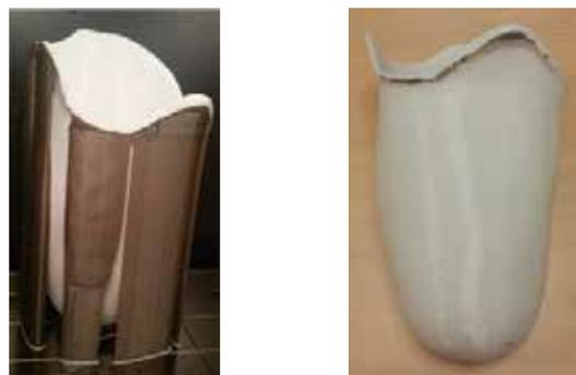
Figura 18 y 19.- Encaje fabricado en FDM con soportes y encaje limpio.
