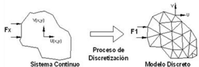
Figura 1.- Modelo discreto con elementos y nodos.
