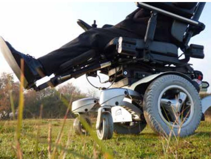
Los actuadores lineales eléctricos hacen posible la elevación del reposapiés, deteniéndolo en la posición que desee el usuario. También regulan la inclinación de la espalda, permitiendo así la basculación a una postura determinada. Además posibilitan un sistema de asiento multiajustable, posicionándola a la altura que mejor convenga. Asimismo hacen posible la elevación total en las sillas de bipedestación, aquellas que facilitan al usuario permanecer en posición erguida.
